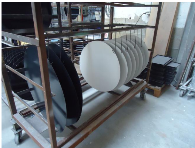
Les plateaux de table ont reçu la base d'accroche en émail puis la sous couche de peinture.
