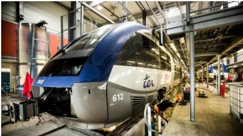
Ces deux ateliers sont équipés de matériels de levage permettant le remplacement des gros organes (moteurs, climatisations, essieux).
